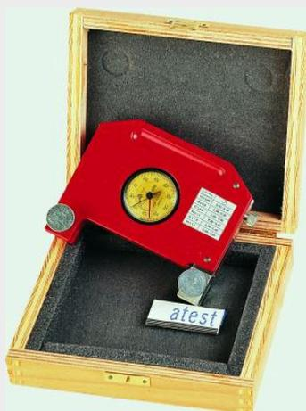
Устройство служит для достижения оптимального уровня натяжения режущего инструмента.
